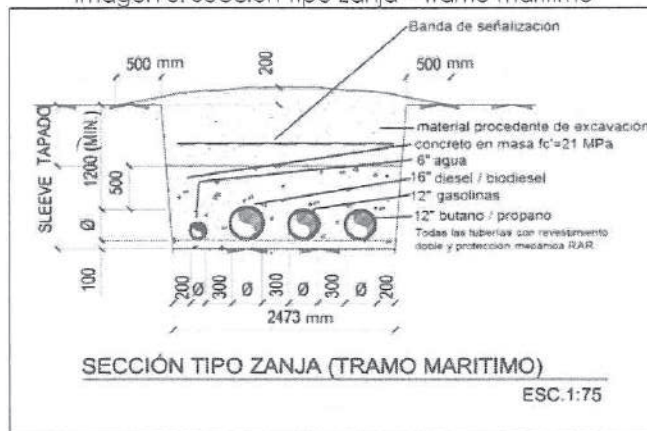
Imagen 3. Sección Tipo Zanja – Tramo marítimo
