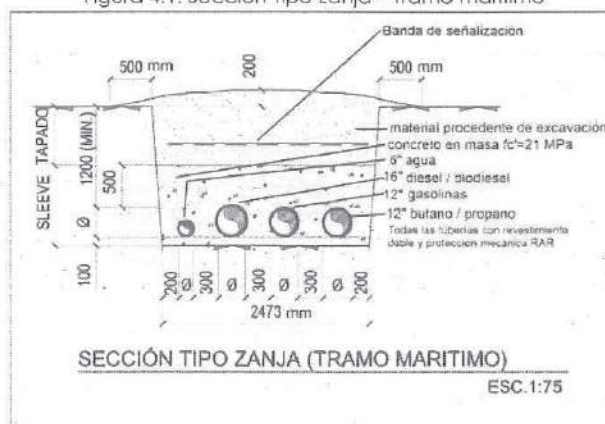
Figura 4.1. Sección Tipo Zanja – Tramo marítimo
