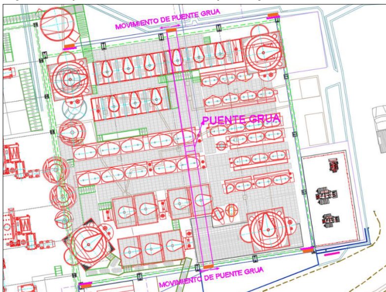
Figura 6. Proyección de la ubicación del puente grúa
