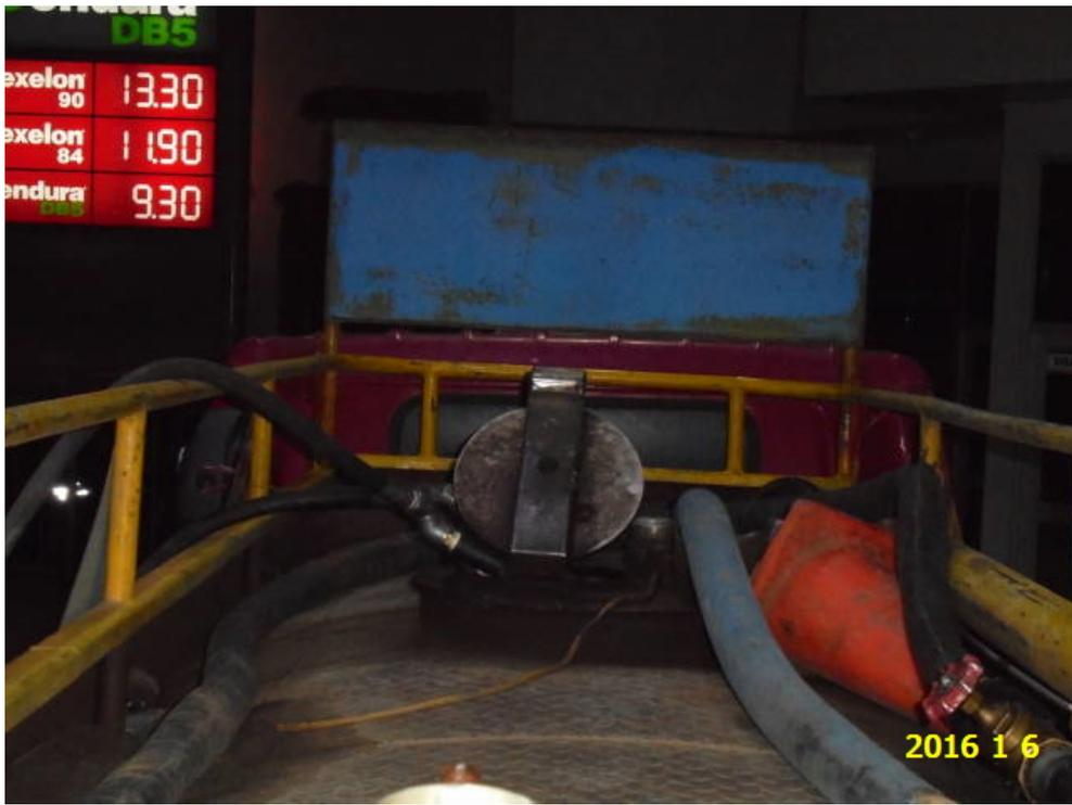
**Foto N° 6:** Vista donde se aprecia las mangueras del dispensador en la parte superior del Camión Tanque (manhole).
