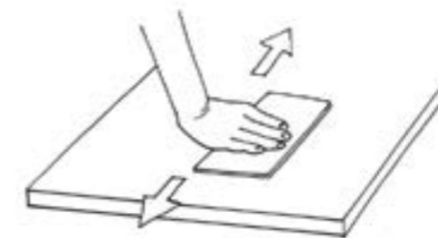
Gráfico N° 18 Lijado directo usando la parte media de los dedos
