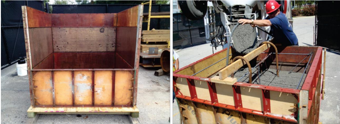
Figura 8: Bloque experimental de concreto masivo [20].
