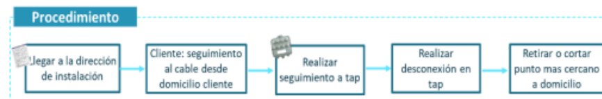
Figura 2. Procedimiento de Retiro de cableado
