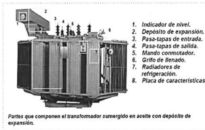
Figura N° 25: Partes del transformador<sup>15</sup>
