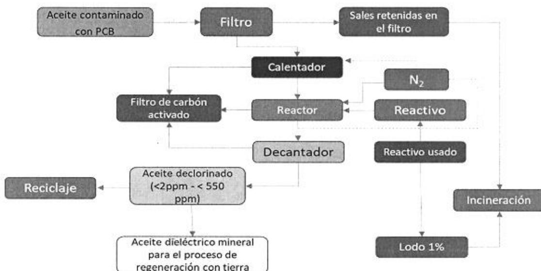
**Figura N° 31: Diagrama del proceso de declorinación**
