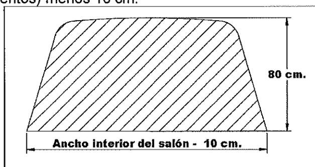
5. El panel debe ir instalado detrás de la primera fila de asientos y fijado a la estructura del vehículo.
