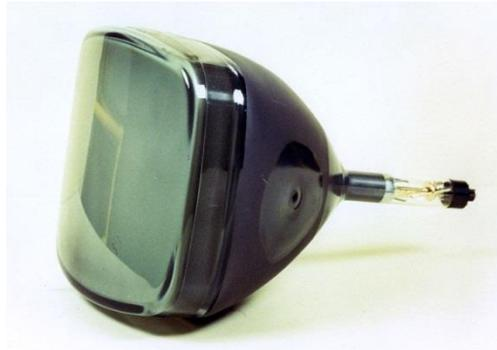
Vidrio del cono contiene óxido de plomo con el fin de absorber la radiación de alta energía
