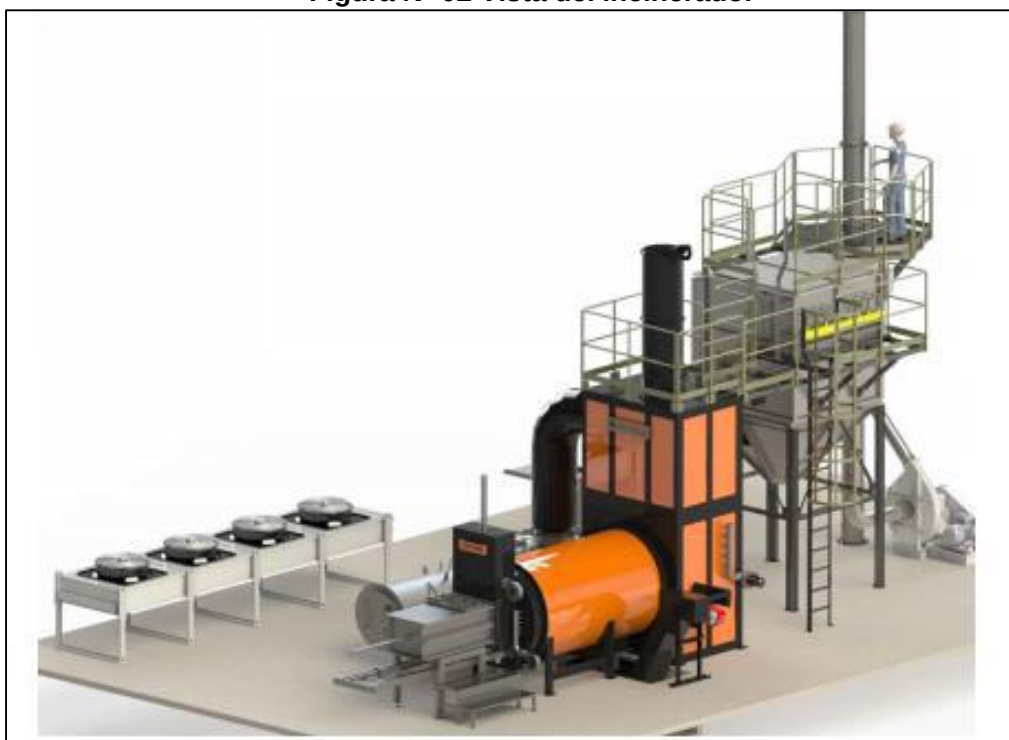
Figura N° 02 Vista del incinerador
