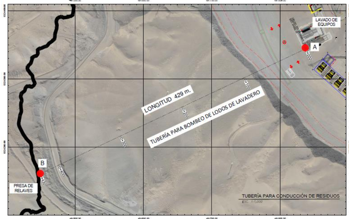
Figura 09. Tubería de conducción de lodos del Truck Shop
