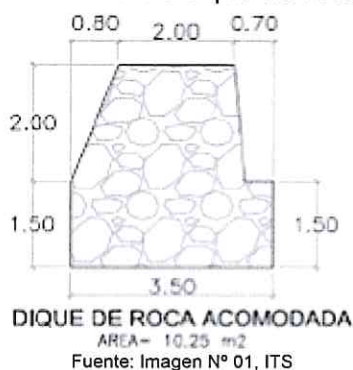
Imagen N° 01: Detalle de dique de roca acomodada
