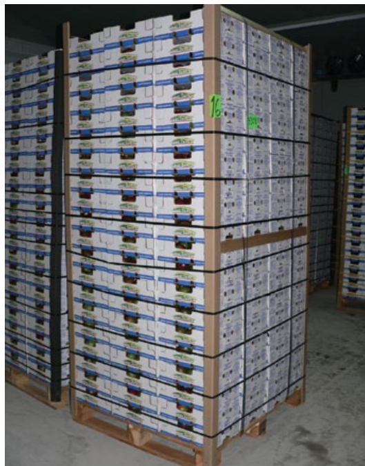
Vista de una esquina de un palet con cuatro lados de entrada, cajas de cartón alineadas de abajo hacia arriba y con lados que se corresponden, esquinas ajustadas y reforzadas, así como un tablón alojado entre las capas de cajas de cartón para mantener una correcta orientación en cuanto al apilado en el palet.
