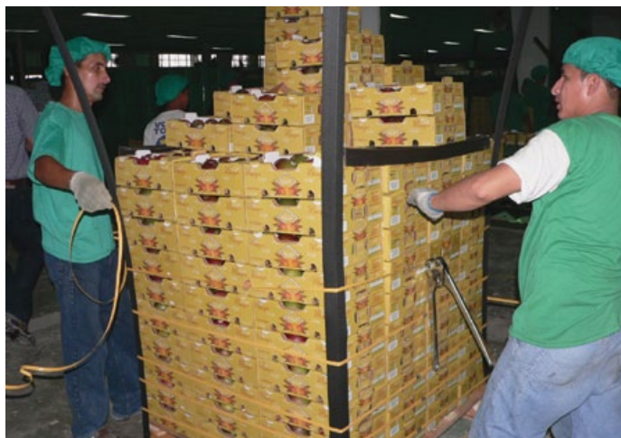
Ajuste y reforzado de esquinas siendo aplicado a un palet conteniendo cajas de cartón de mangos en su paletizado
