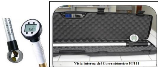
Seleccionar el tipo de medición (AVG, MAX, MIN) con el botón "MODE".
