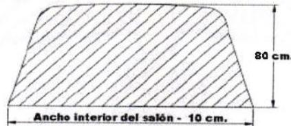
5. El panel debe ir instalado detrás de la primera fila de asientos y fijado a la estructura del vehículo con un mínimo de 4 anclajes en L.
