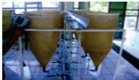
Imagen N° 14: Incubadoras de flujo de agua invertido
