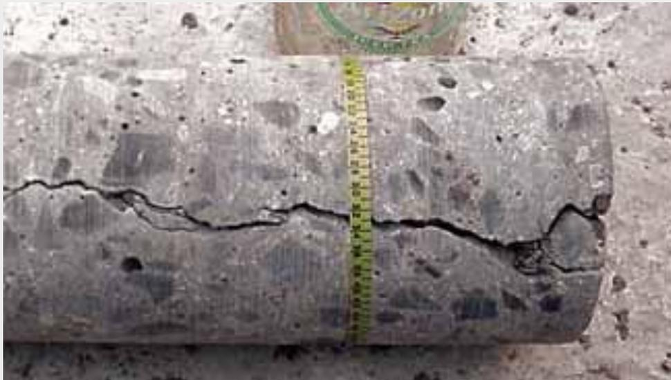
*Figura 2: Una diamantina de concreto extraído de la base de una cimentación muestra el grado de fisuración térmica.[16]*
