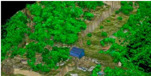
Figura 4: Representación de la nube de puntos con textura y filtrado superpuesto de la vegetación sólo desde el LIDAR.
