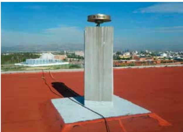
Figura 2: Estación GNSS
