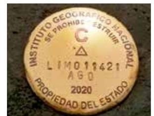
Figura 6: Punto de Control Terrestre Horizontal - Vertical N°3.
