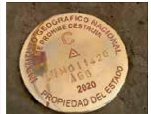
Figura 5: Punto de Control Terrestre Horizontal - Vertical N°2.
