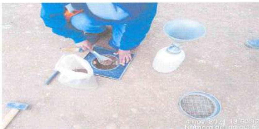
KM. 6+450 LADO IZQ SEPTIMA CAPA, CONTROL DE COMPACTACIÓN POR EL METODO CONO DE ARENA MARGEN DERECHO
