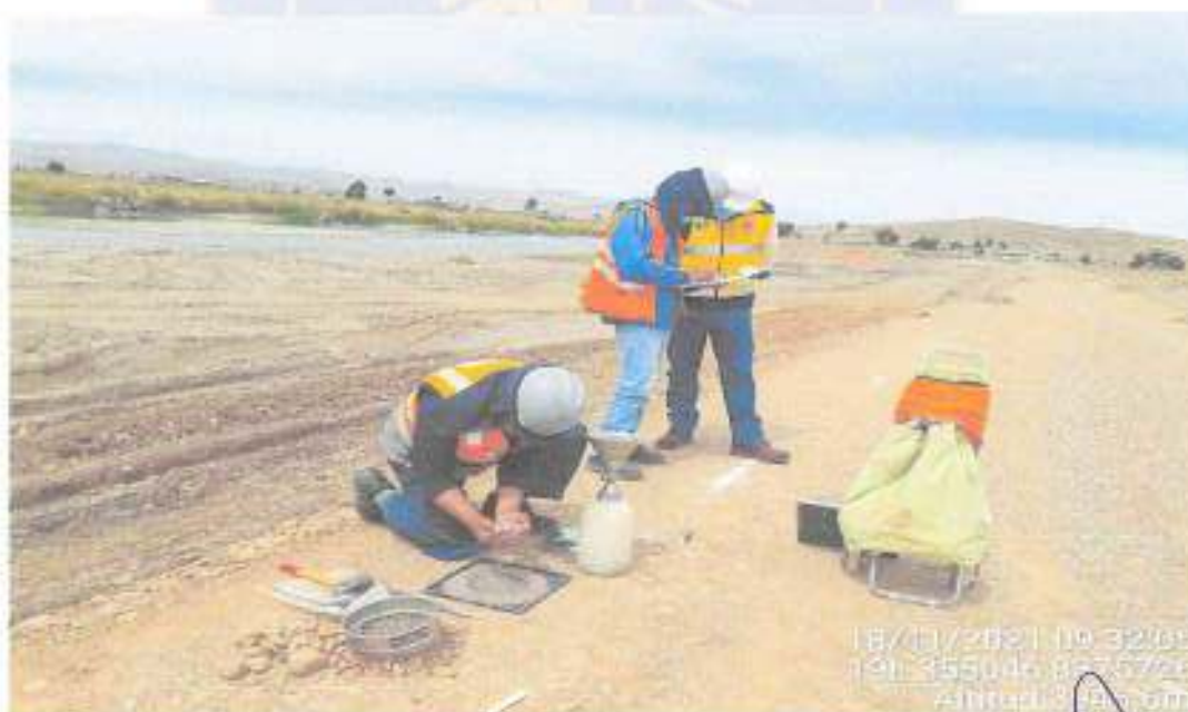
KM. 6+450 LADO IZQ SEPTIMA CAPA, CONTROL DE COMPACTACIÓN POR EL METODO CONO DE ARENA MARGEN DERECHO
