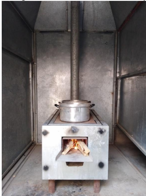
Fig. 4. Prueba de emisiones fugitivas con el modelo de cocina Illapa Fritz con horno
