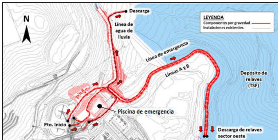
Gráfico N° 7.- Sistema de transporte de relaves gravitacional
