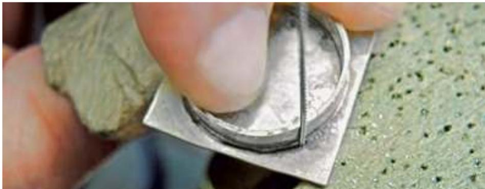
**c) Chapa:** consiste en la introducción de la piedra en el metal, mediante el taladrado del mismo para, seguidamente, sujetar la piedra mediante virutas de metal.
