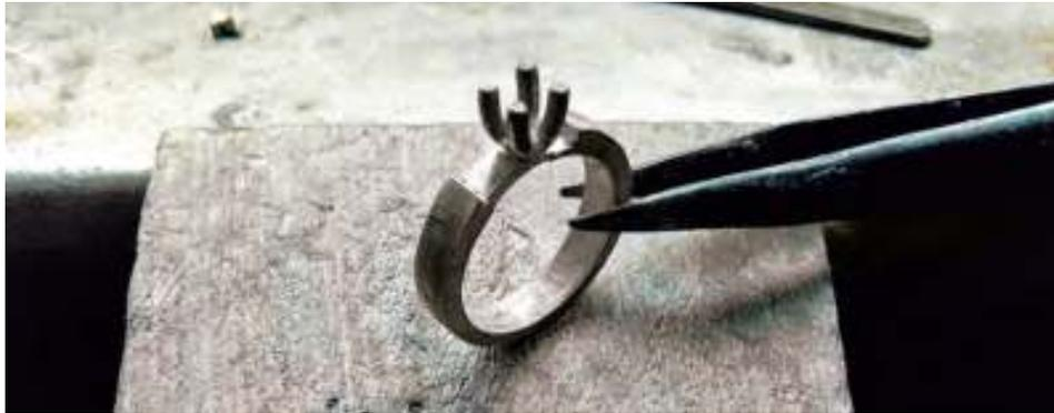
**b) Bocel:** es la sujeción de la gema o piedra mediante un cinturón de metal que la rodea.
