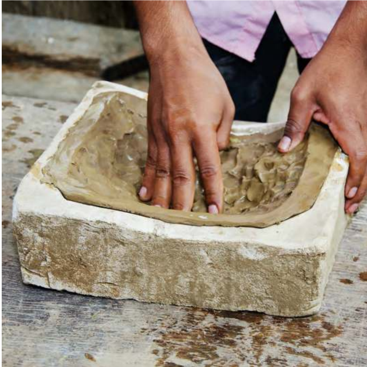
Colocación de arcilla en el molde de yeso
