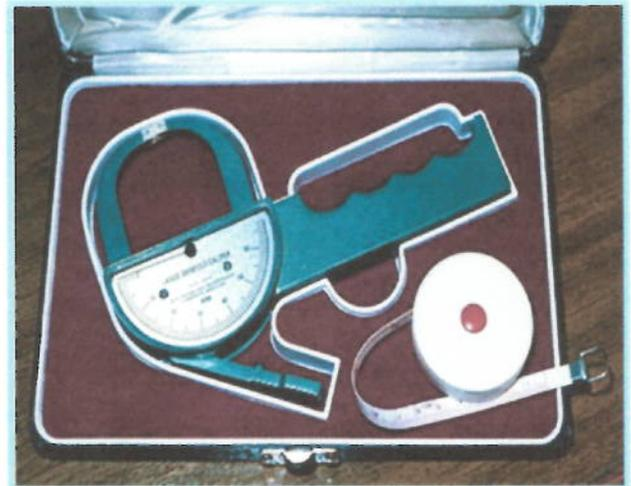
**Figura 2: Plicómetro Harpenden**
