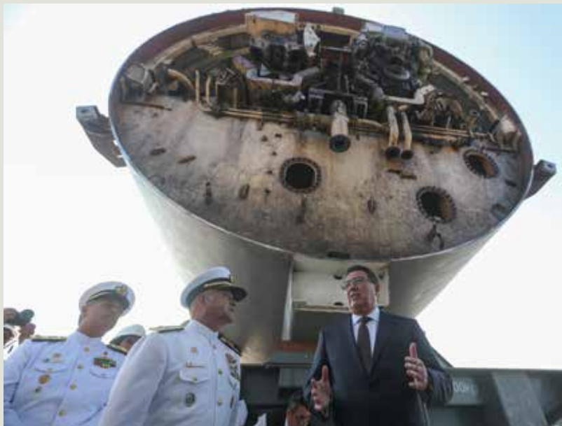
Una parte del submarino cortado en dos para proceder a su completa reparación en los astilleros del SIMA... Un trabajo de alta tecnología...
