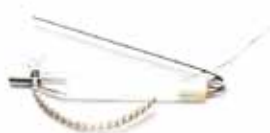
Artilugio 4: Engastador y cadeneta H (Para construir cadenetas y engastar piedras)
