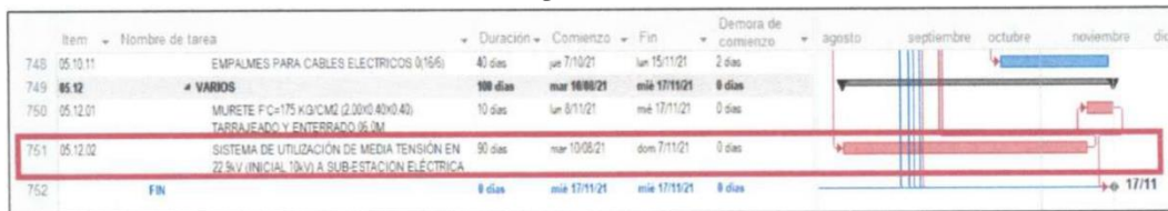
Imagen 1: Modificación de la ruta crítica por afectación de la partida 05.12.02 "Sistema de Utilización de Media Tensión en 22.9kV (inicial 10kV) a Sub-Estación Eléctrica".
