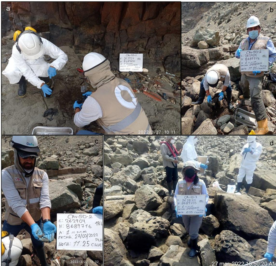
**Figura 8.9.** Vista del entorno, observación organoléptica y muestreo de sedimento intermareal en los puntos CAV-SD-1 (a), CAV-SD-2 (b y c) y CAV-SD-3 (d)
