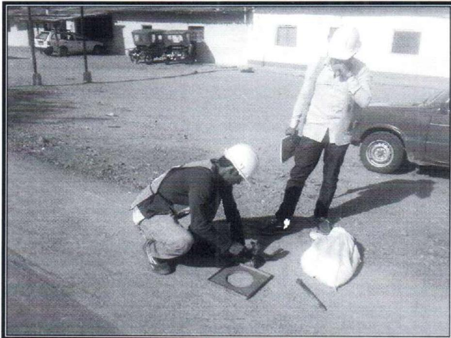
Toma N° 32: Ensayos de Densidad de Campo a Nivel de Base Granular en Bermas.
