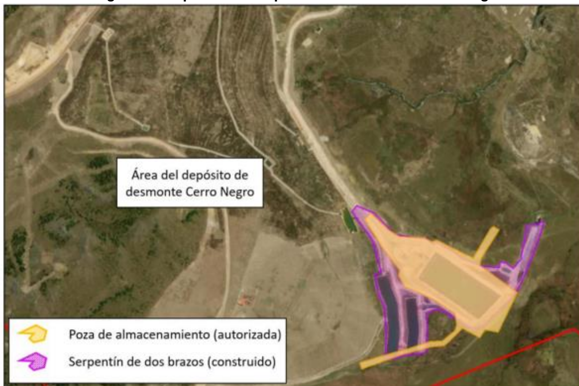
Figura 6. Serpentín del depósito de desmonte Cerro Negro
