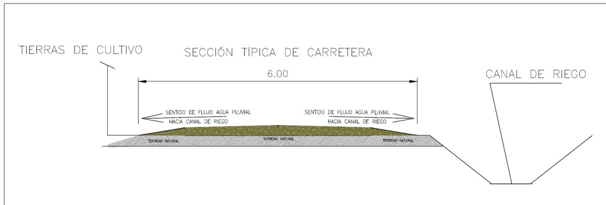
a.5.2. Mejoramiento de sub rasante  $e=0.30\text{m}$  en tramo crítico de la progresiva 3+500 a la 4+500, debido a que se han podido identificar suelos inadecuados, expansivos, de baja capacidad de soporte CBR, índices de plasticidad superiores a 11.0% y suelos saturados, situación que en condiciones de periodos lluviosos podría afectar la integridad de la estructura.
