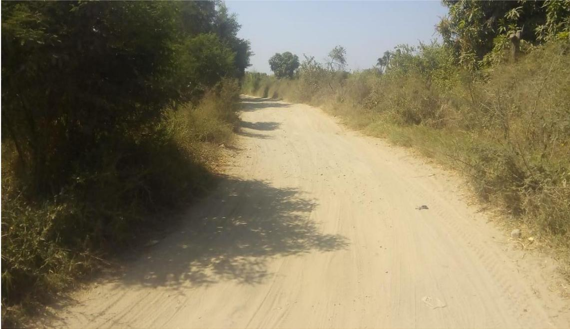
Foto 03: vía sin superficie de rodadura definida, falta de señalización.
