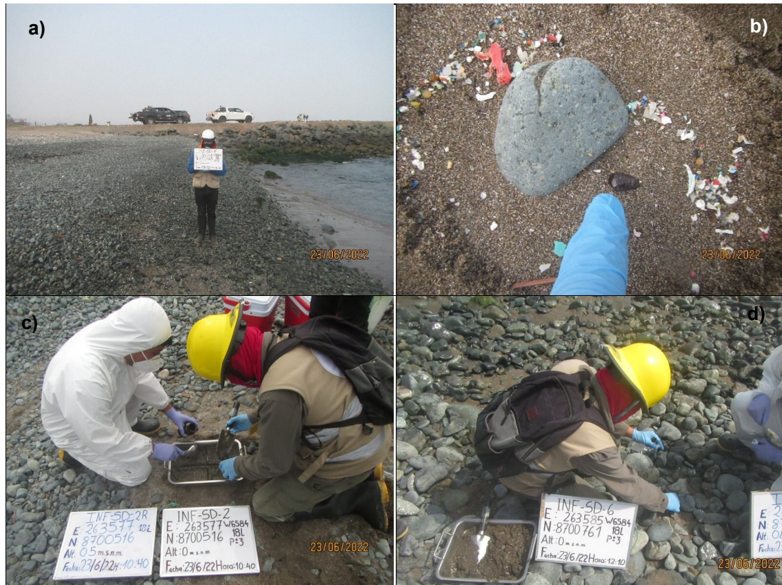
Figura 8.2. Vista panorámica del muestreo de sedimento intermareal en punto INF-SD-1 (en a), sedimento con restos de hidrocarburos de petróleo (gotículas) en el punto INF-SD-1 (en b), muestreo de sedimentos en el punto INF-SD-2 (en c). y muestreo de sedimento residual con restos calcáreos en el punto INF-SD-6 (en d)
