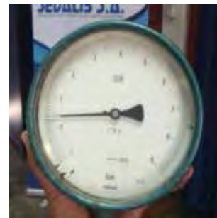
Ilustración 109: Manovacuómetro. Nótese la escala bajo cero. Fuente: Imagen del autor.
