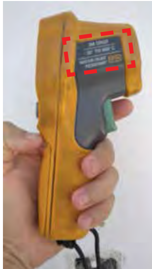
Ilustración 23: Importante saber el rango de medición de temperatura, para nuestro caso -30 °C a 650 °C. Fuente: Imagen del autor.
