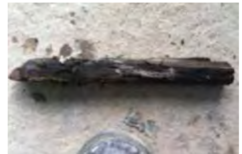
Ilustración 91: Vista del pedazo de madera que originó la falla en la EBAR. Fuente: Imagen del autor.
