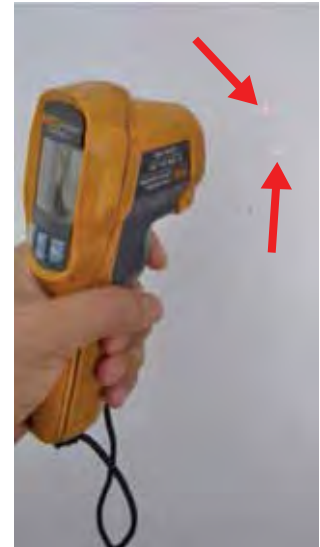
Ilustración 24: Los puntos rojos señalan el área donde el medidor registra la temperatura al apretar el gatillo. Fuente: Imagen del autor.
