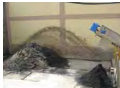
Ilustración 73: Se aprecian los sólidos extraídos del desarenador, dispuestos de mala manera. Fuente: Imagen del autor.
