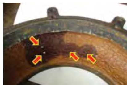
Ilustración 81: Se señalan las perforaciones de la carcasa. Fuente: Imagen del autor.
