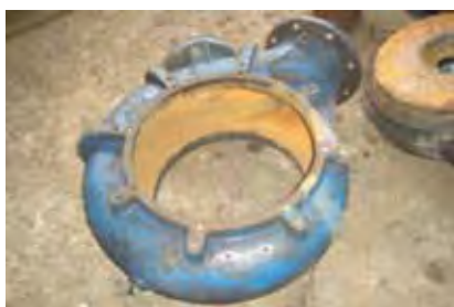
Ilustración 76: Vista de una carcasa de una bomba de EBAR.
