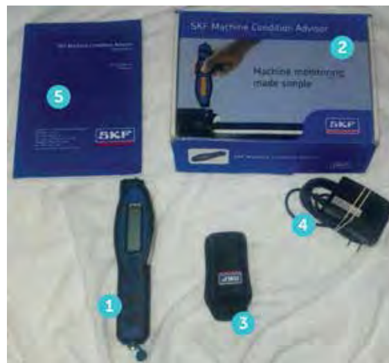
Ilustración 27: Se aprecia el (1) vibrómetro con su (2) caja, (3) portacinto, (4) cargador AC/DC y (5) manual. Fuente: Imagen del autor.
