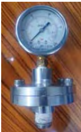
Ilustración 113: Vista del conjunto diafragma + manómetro. Fuente: Imagen del autor.
