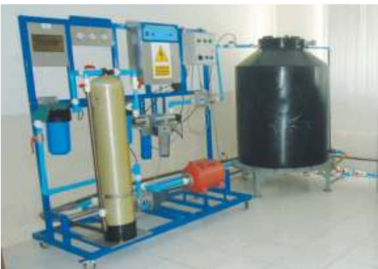
Planta de agua ozonizada
