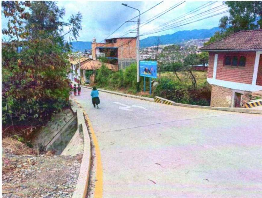
**FOTOGRAFÍA N°01:** Inexistencia de paso peatonal, corte de circulación peatonal mediante vereda.
