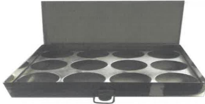
**Figura 3.** Caja de acero para transporte de muestras
