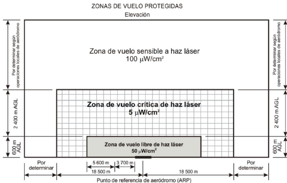
Figura D-1-3. Zonas de vuelo protegidas con indicación de niveles máximo de irradiación para haces láser visibles
