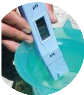
Muestra de agua es analizada con peachimetro para medir su acidez o alcalinidad.
