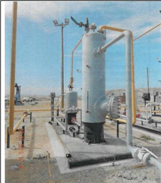
Volumeter, activo, indicador de presión 0-100 psi, controlador de PLC. Capacidad 2 Bls.
