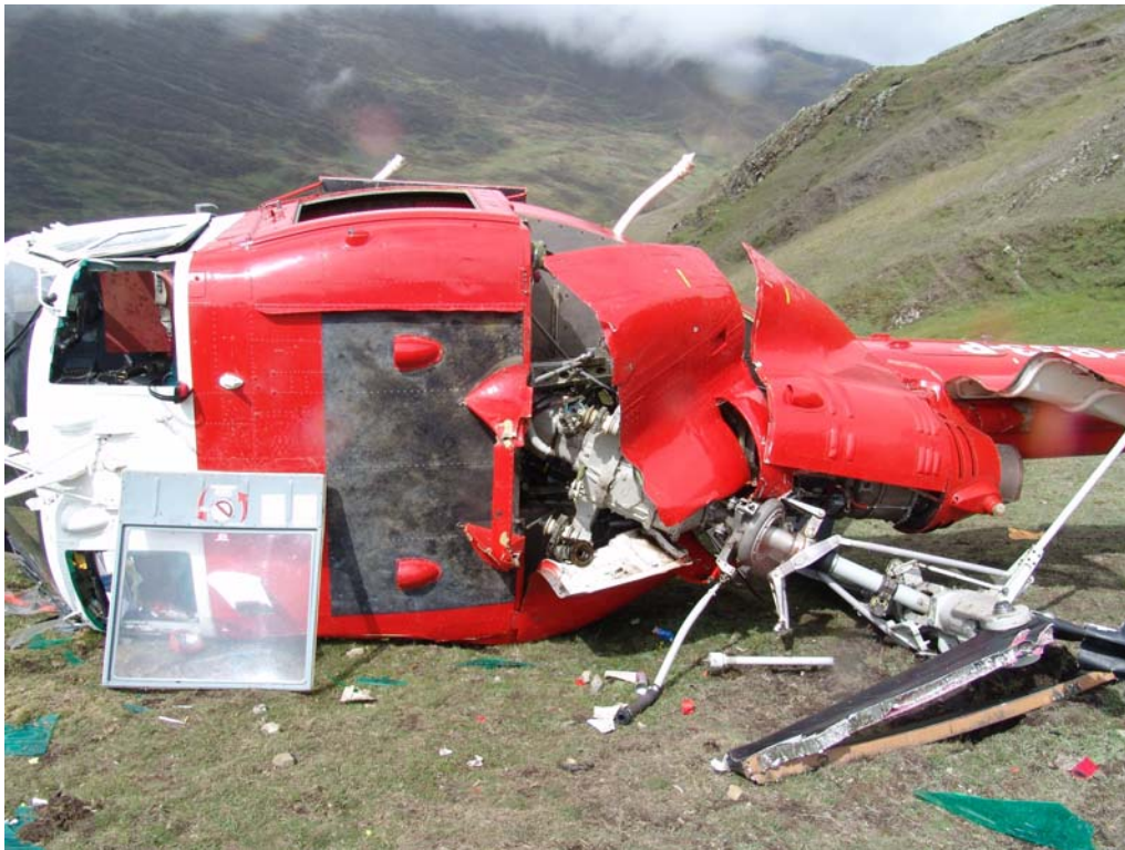
Foto de la posición de la transmisión y del motor en los restos del helicóptero accidentado.
