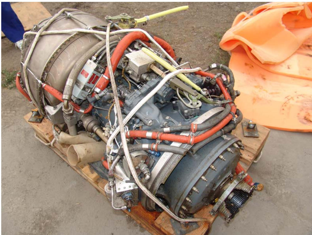
Foto del motor Honeywell T5313B, N/S: LE-07751 ya retirado de los restos del helicóptero.
