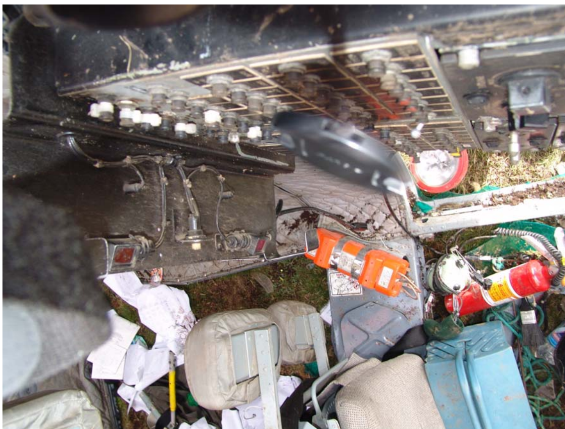
Fotografía de la unidad de ELT localizado en la parte izquierda del helicóptero accidentado.
