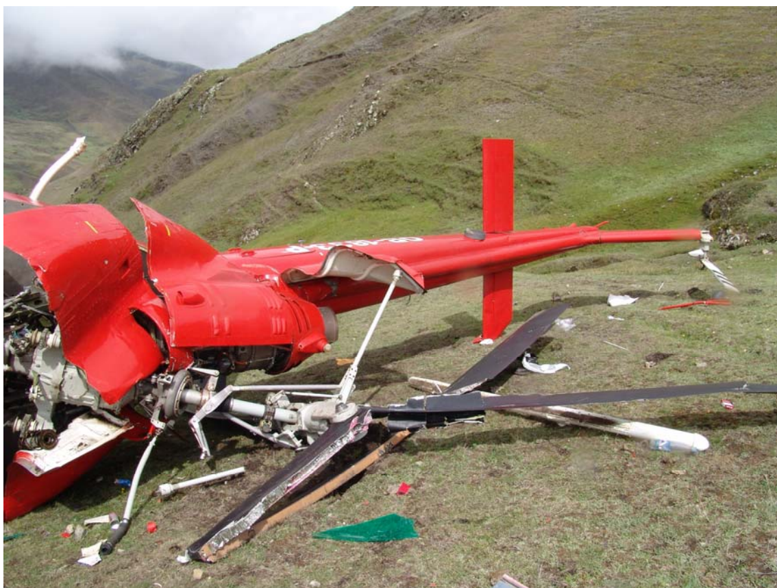
Fotografía de las palas del rotor principal y del rotor de cola en los restos del helicóptero accidentado.
