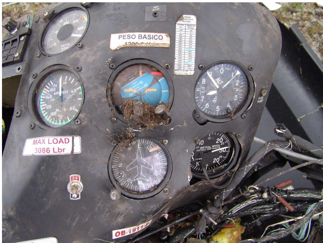
Fotografías del panel de instrumentos con la unidad de VEMD ya retirada
