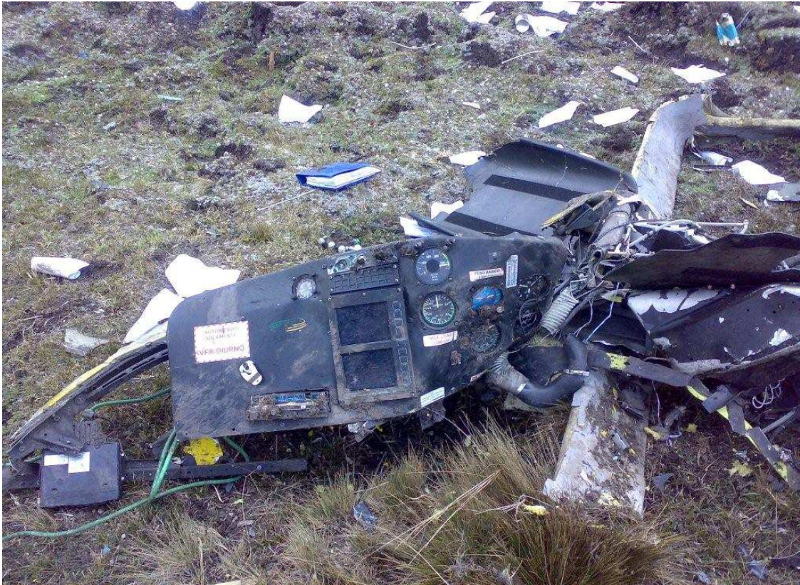
Fotografía de la posición como fue encontrado el panel de instrumentos y luego de voltearlo para poder extraer la unidad de VEMD.
