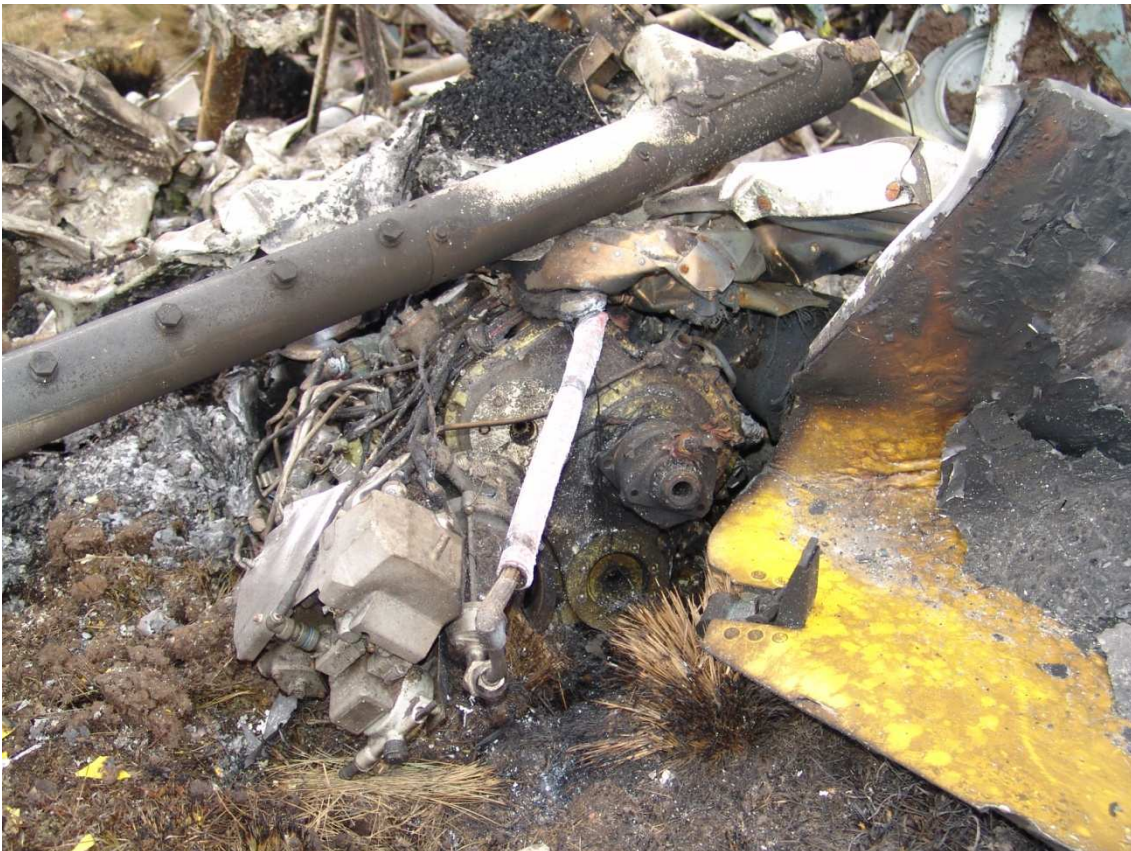
Fotografía de los restos del motor dañado por la exposición al fuego y por las fuerzas de impacto.
