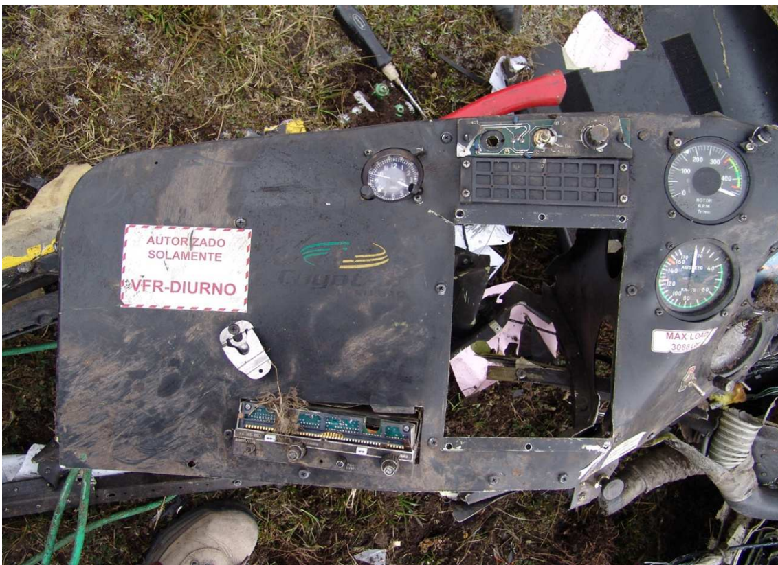
Fotografía de la posición como fue encontrado el panel de instrumentos y luego de voltearlo para poder extraer la unidad de VEMD.
