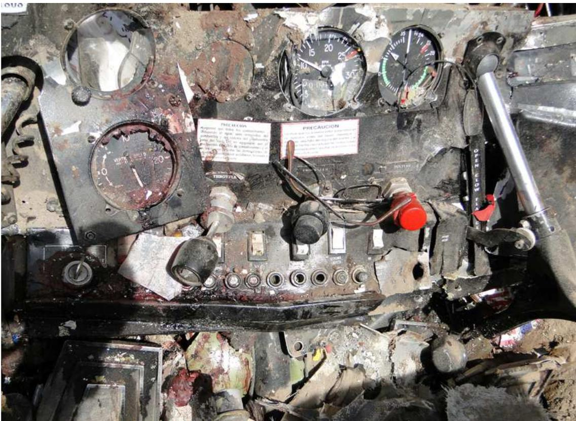
Fotografía del panel de instrumentos y los controles de potencia del motor, mixture y hélice.
