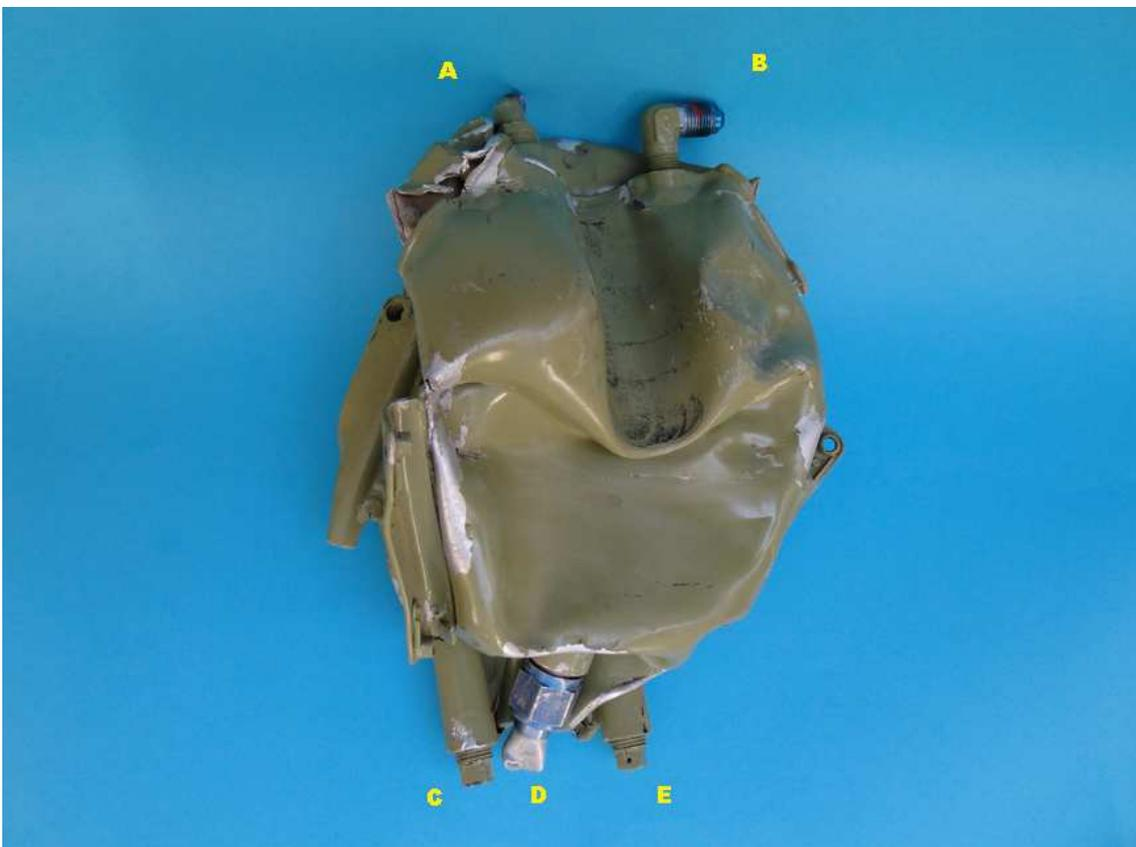
Fotografías del tanque colector de combustible.
