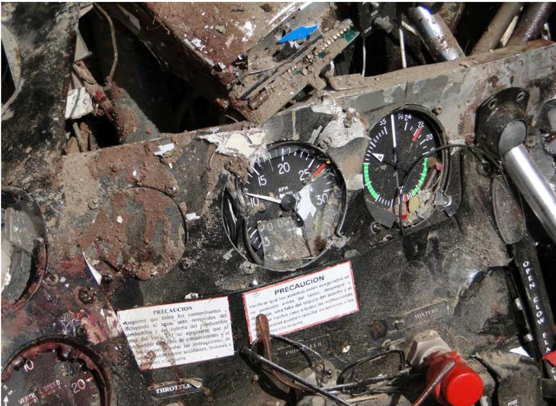
Fotografía del instrumento indicador de RPM.
