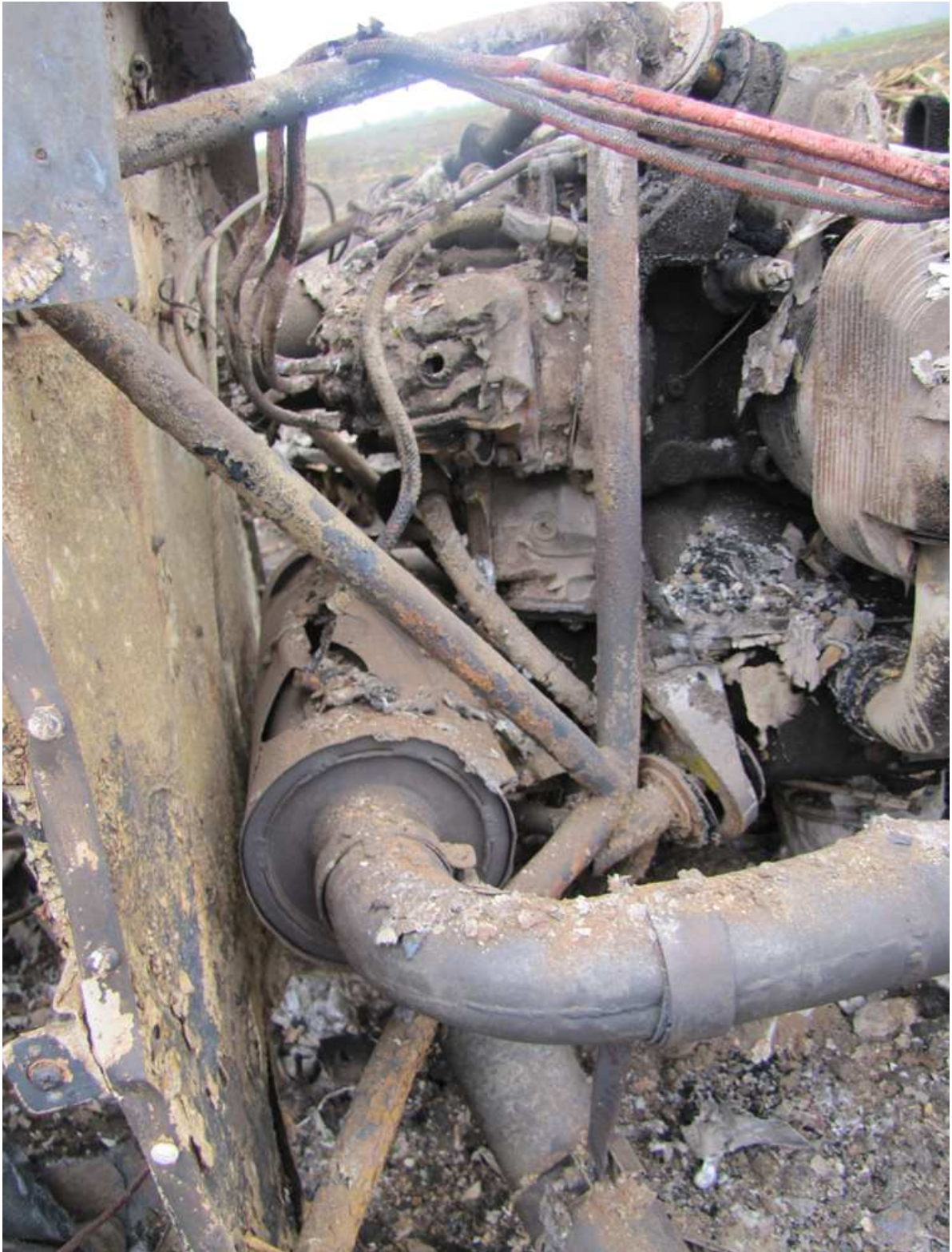
Daños ocasionados por el incendio. Nótese las fracturas producidas en los tubos intermedio y externo de escape, en aquellas zonas de mayor concentración de energía térmica y vibracional.
