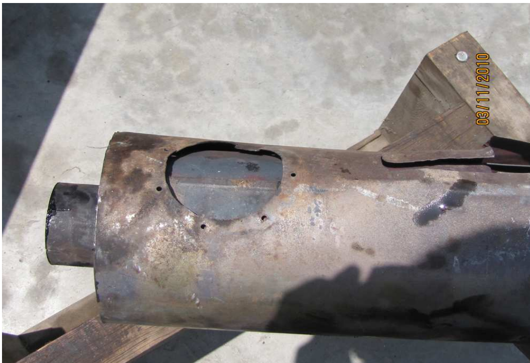
Tubo de escape lado izquierdo, nótese los 6 puntos de sujeción de los remaches que lo sujetaron a la "toma de ingreso de la manguera de aire de impacto" que refrigera el sistema, el tubo intermedio se encuentra en buenas condiciones.
