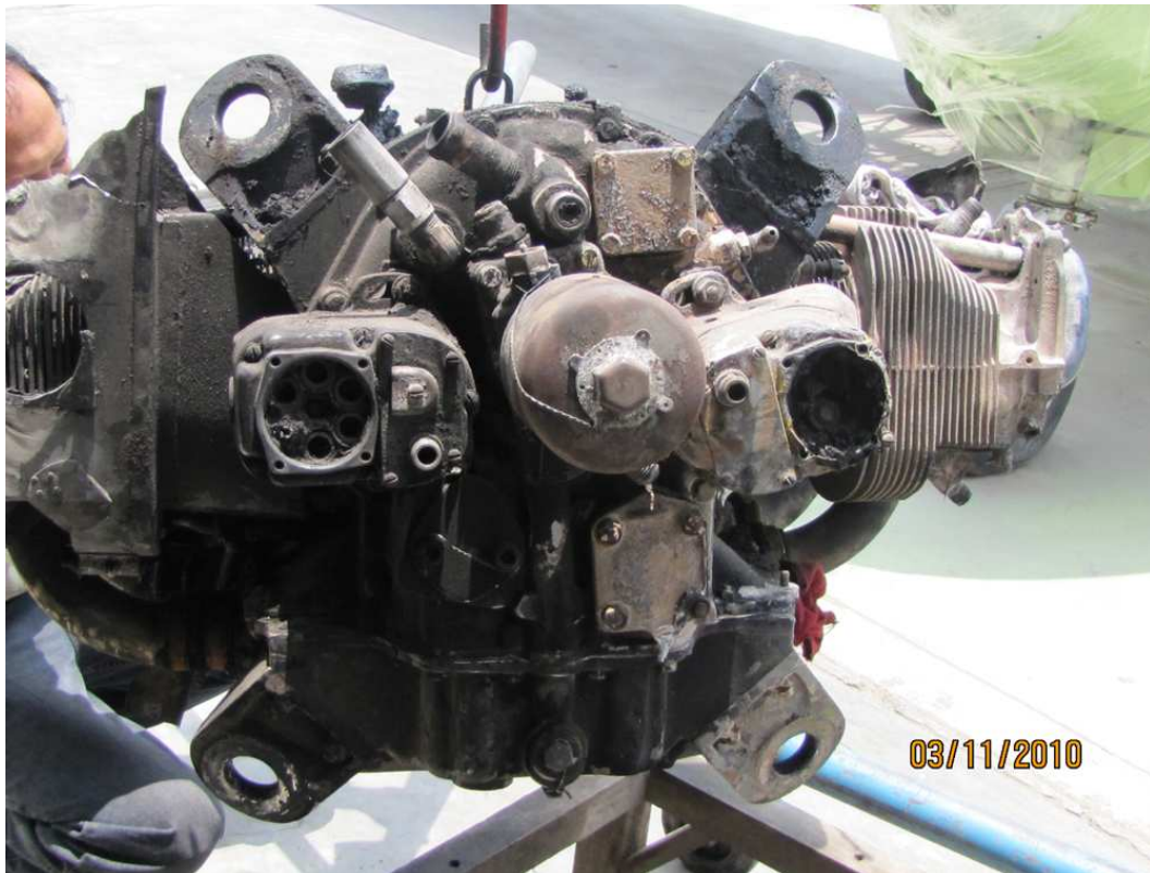
Fotografía comparativa del estado en que quedaron los dos magnetos luego de producirse el incendio. Nótese los daños externos e internos del "magneto derecho".
