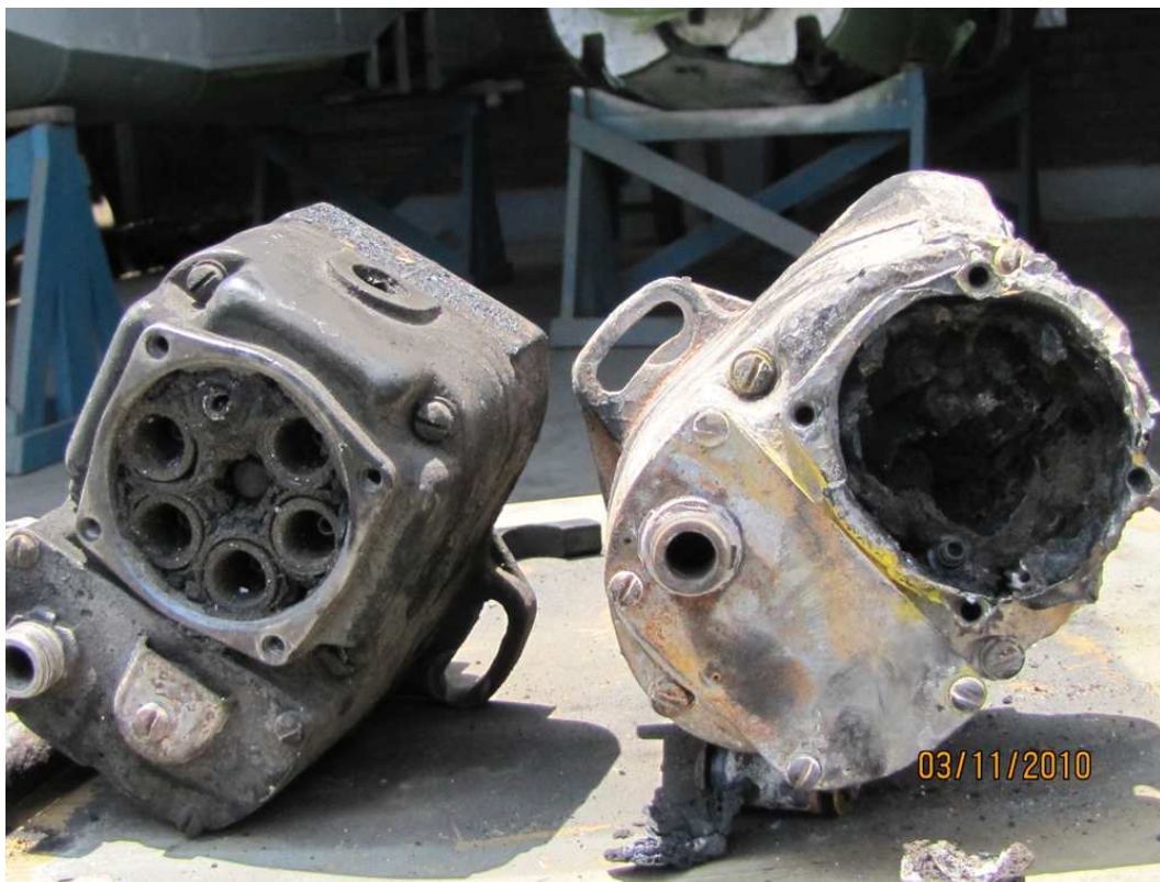
Fotografía comparativa del estado en que quedaron los dos magnetos luego de producirse el incendio. Nótese los daños externos e internos del "magneto derecho".
