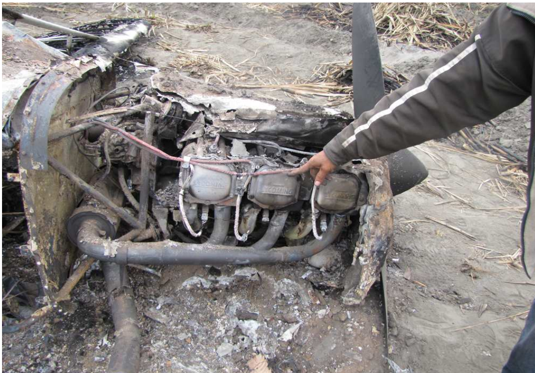
Daños ocasionados por el incendio. Nótese las fracturas producidas en los tubos intermedio y externo de escape, en aquellas zonas de mayor concentración de energía térmica y vibracional.
