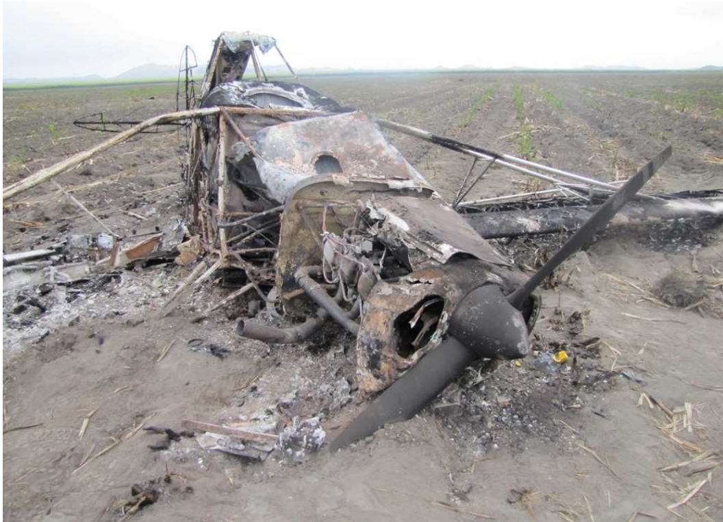
Daños en el motor lado derecho. Obsérvese el tubo colector de los gases de salida de los 3 cilindros sin desconexiones, nótese el estado del tubo de salida del escape sin daños por impacto.
