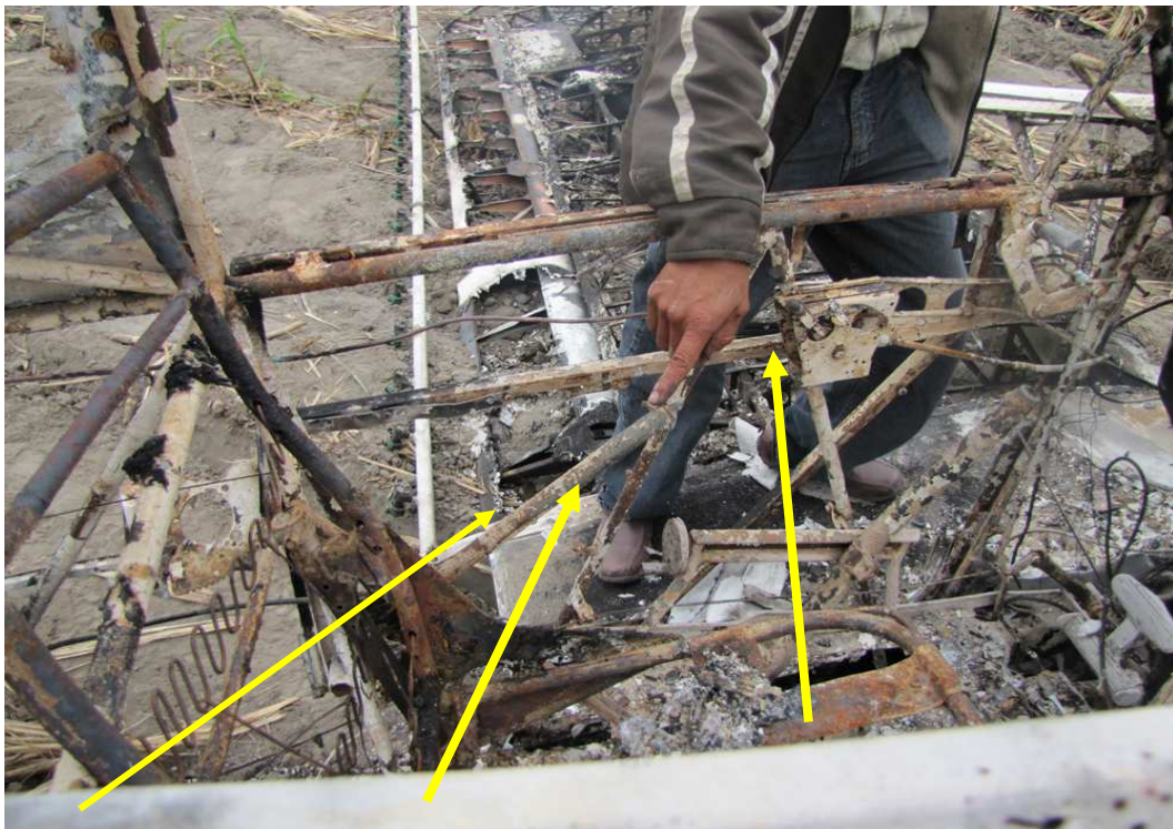
Ala izquierda flaps actuados 40° abajo, Bastón de flaps en posición de 40° abajo, Posición de Manetas: Acelerador: Atrás "Cerrado", Mezcla: Atrás "Off".
