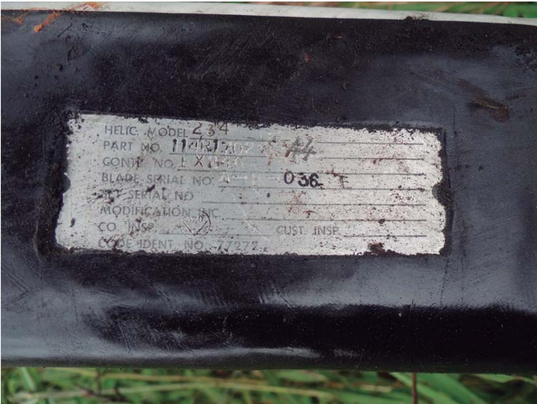
Placa de datos de la pala "verde" del rotor trasero.
