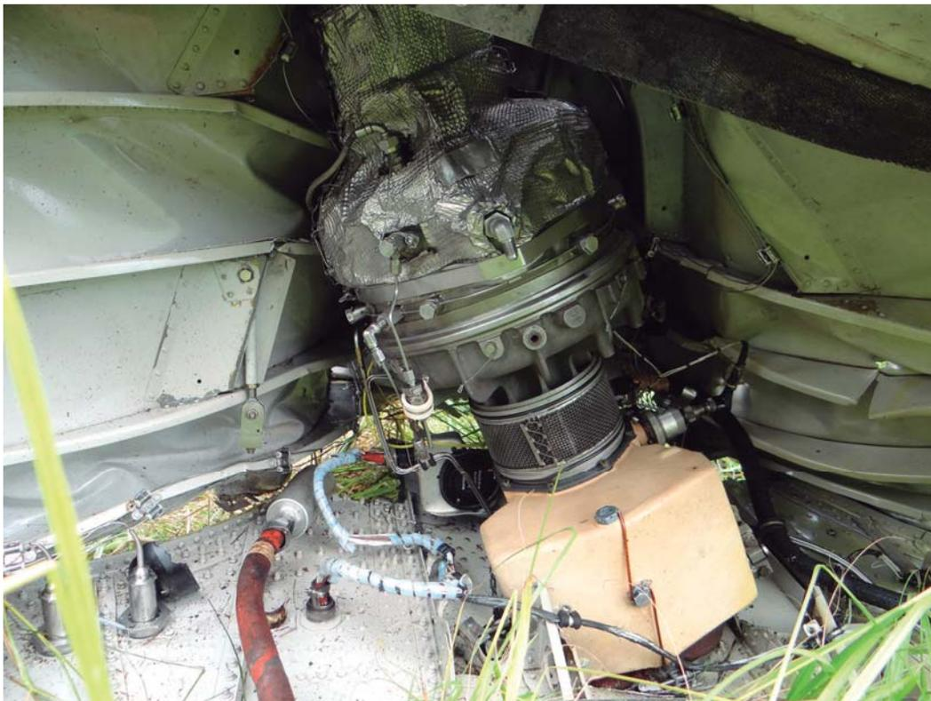
Detalle del APU del helicóptero.
