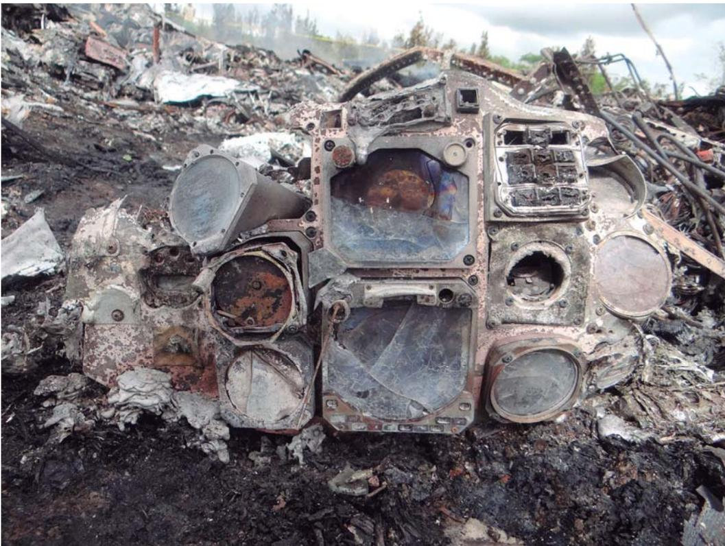
Segundo panel de instrumentos de la cabina de mando del helicóptero accidentado.
