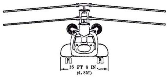
Dimensiones del helicóptero BV234, N241CH.
