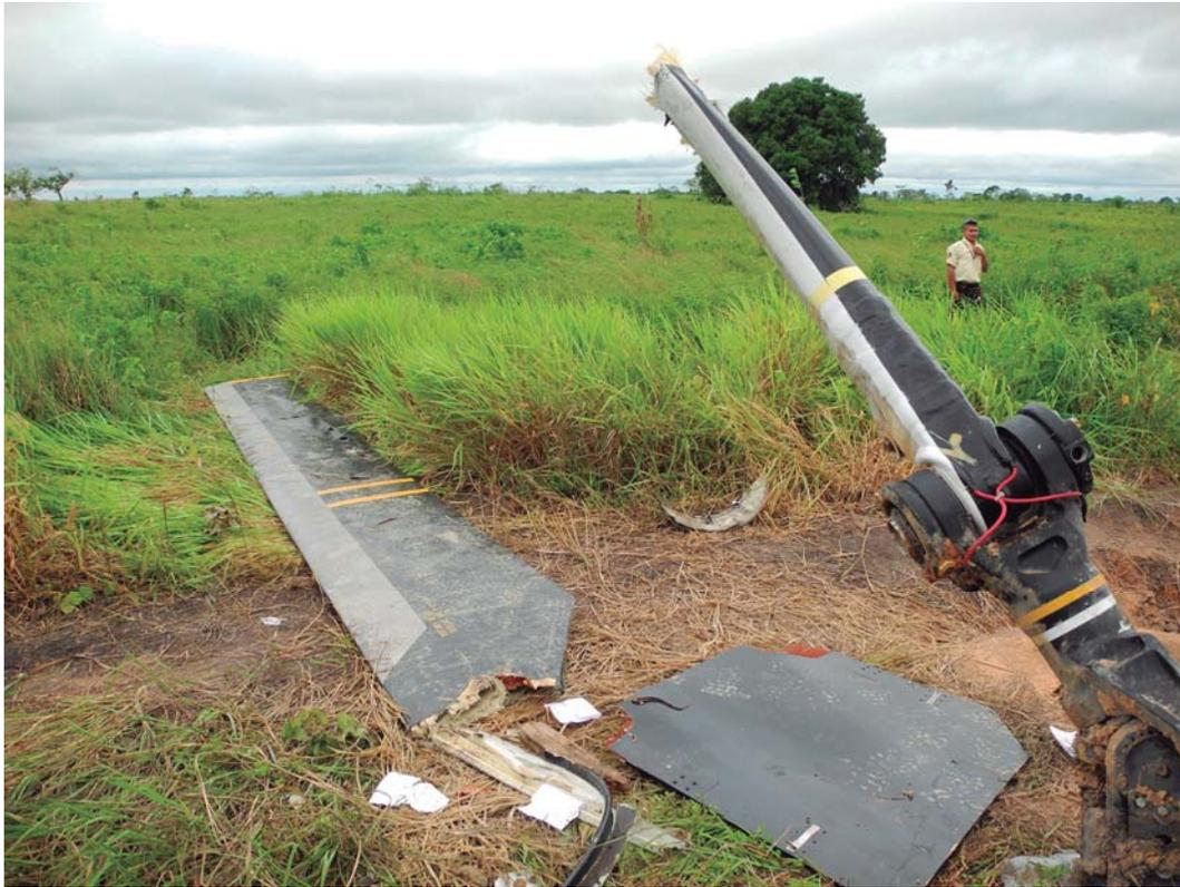
Fotografía de la pala "amarilla" del rotor trasero.
