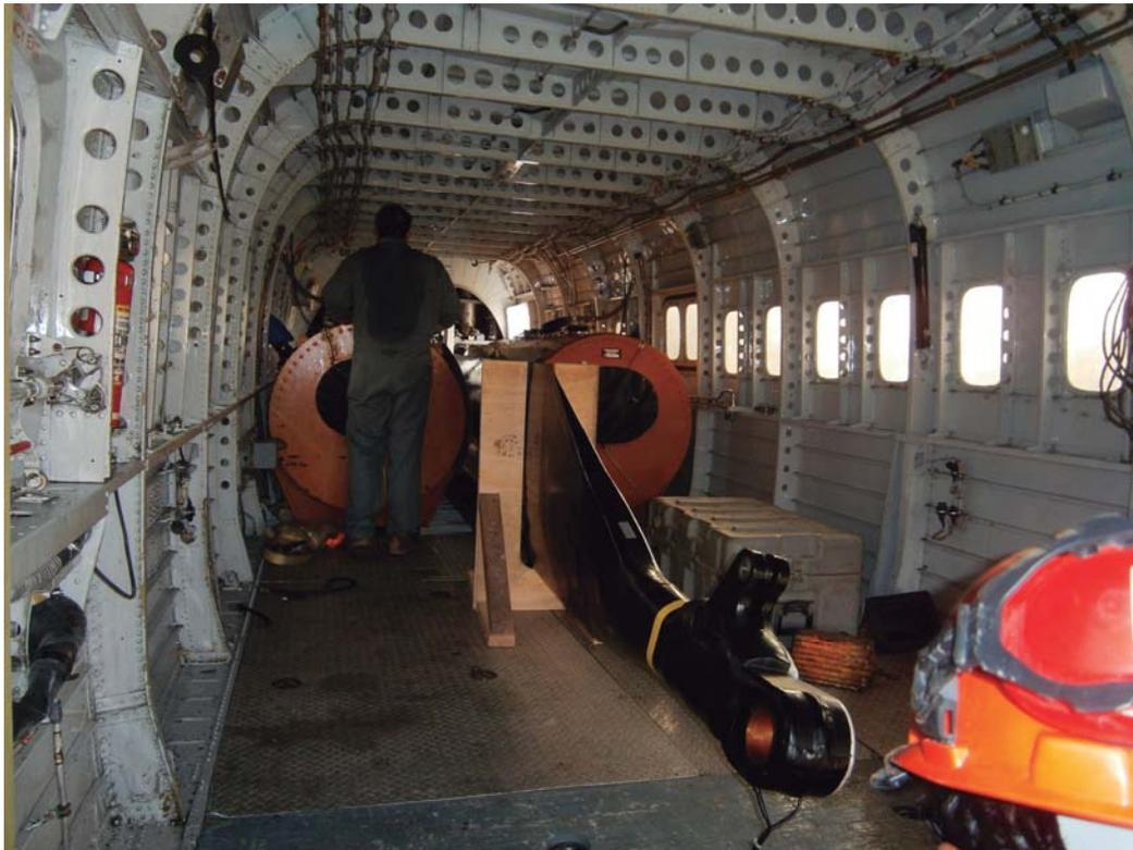
Fotografía de la posición de los tanques de combustible dentro del helicóptero.
