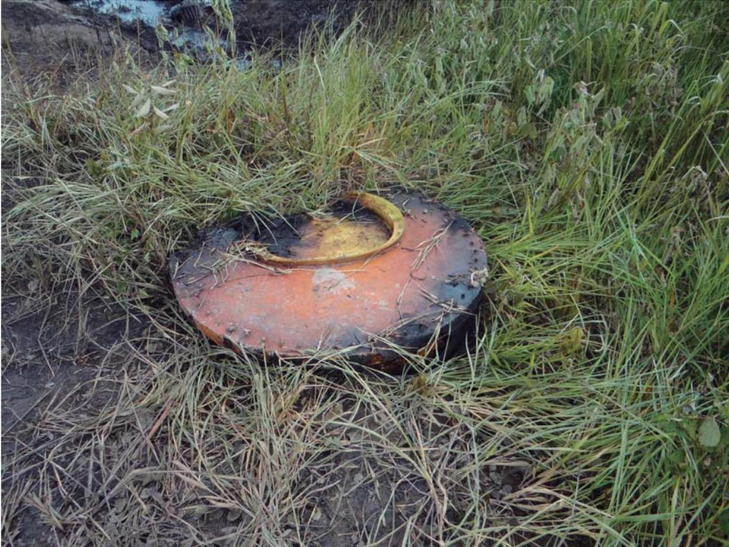
Tapa de uno de los tanques principales de combustible ubicado a 60 m aproximadamente de los restos principales del helicóptero accidentado.
