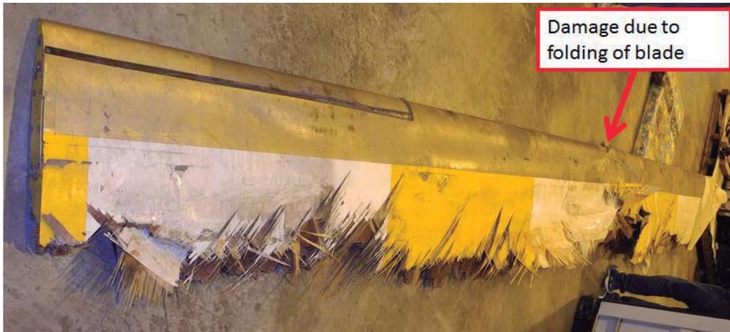
Fotografía de la envergadura de la pala "verde" del rotor posterior. La flecha roja nos señala el área donde la pala se dobló cerca a la estación RSTA 195.
