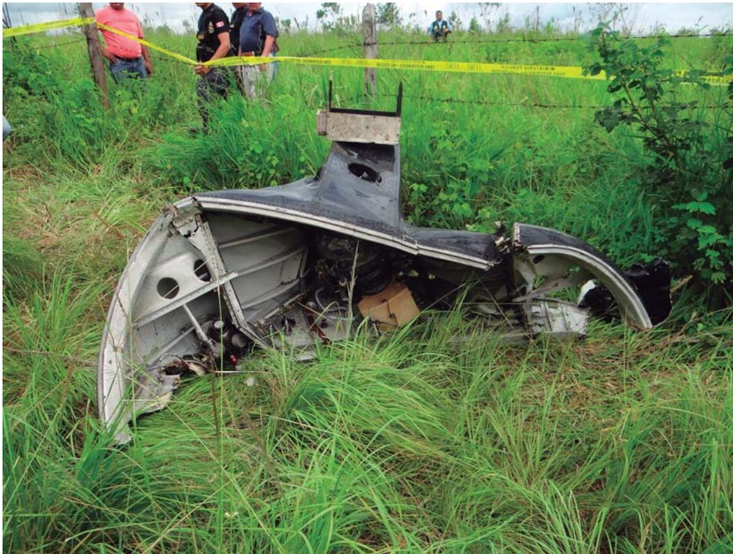
Parte posterior del fuselaje donde se encuentra el APU del helicóptero.
