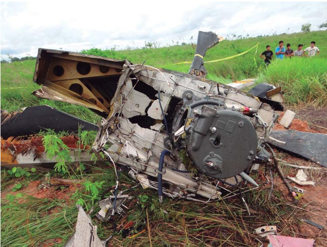
Parte inferior de la estructura del pilón trasero.
