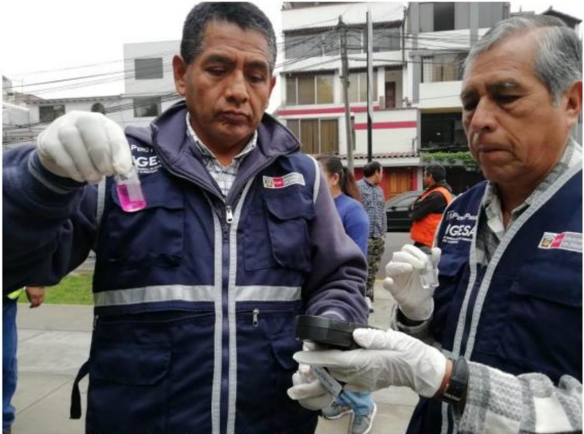
**Brigadas de DIGESA realizando las mediciones de cloro residual en el agua para consumo humano e inspección de las condiciones sanitarias en los puntos de abastecimiento**
