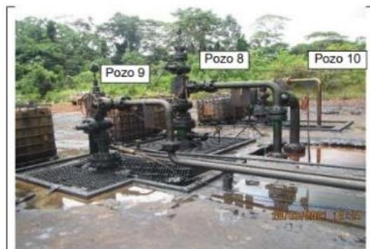
**Fotografía N° 03** Vista panorámica de los pozos productores 9 y 10, además del Pozo de inyector 8 del Yacimiento Forestal registrado con fecha 28 de marzo de 2021. Se evidencia los cabezales de los tres (3) pozos impregnados de petróleo crudo, manifestado de color negro.
