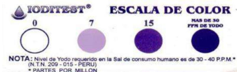
Figura 3. Método colorímetro visual de medición de yodo en sal
