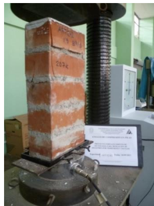
Figura 4. Ensayo de compresión axial de pilas
