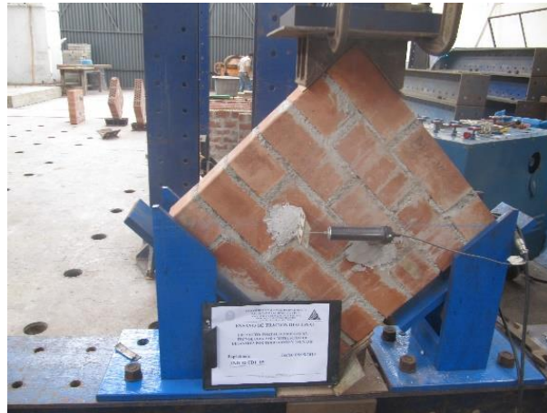
Figura 5. Ensayo de resistencia al corte de muretes
