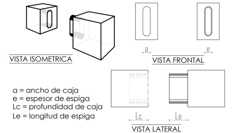
Tolerancia de ancho de caja (a) =+/- 0.2 mm
