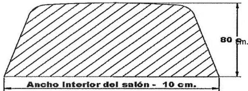
5. El panel debe ir instalado detrás de la primera fila de asientos y fijado a la estructura del vehículo.
